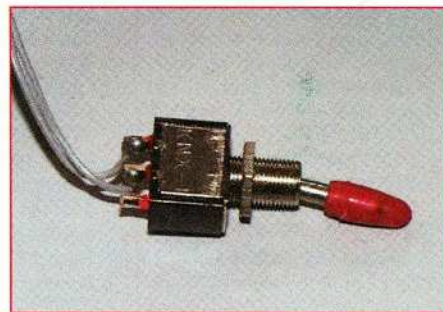
Der Deckelschalter-Umbau: Schraubt Eure Playstation auf, entfernt das Schutzblech und sucht den Schalter, auf den die Nase des CD-Deckels drückt (links, Pfeil). Lötet an die beiden rechten Kontakte das zweiadrige Kabel (Mitte) und an die andere Seite den Kippschalter (rechts).
